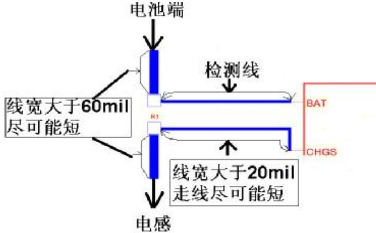
10mohm 电阻两端和 IC 的 BAT/CHGS PIN 相连的走线,需要单独从 R1 两端焊盘引出,不能和 BAT/CHGS 网络的其他走线重合,如上图所示。
